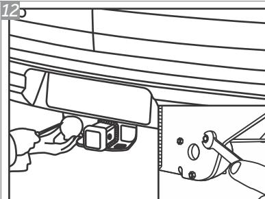
Posicione a Tomada "I" no conjunto estrutura nas furações indicadas e insira os Parafusos "B", com Porcas "E". Para fixar a tomada, utilize a chave phillips e chave 8.
