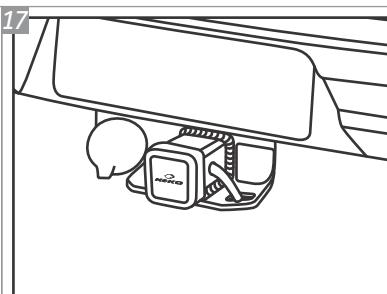
Após colocada, a tampa de proteção deverá ser fixada com o Pino Travá "K" e com o Grampo "J" afim de evitar a perda da mesma.
