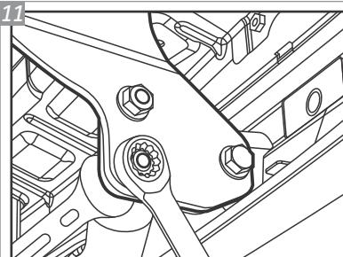
Posicione o Conjunto Estrutura "M" entre os Suportes "L" e fixe-os com Parafusos "A" e Porcas "D". Dê aperto final em todas fixações.
