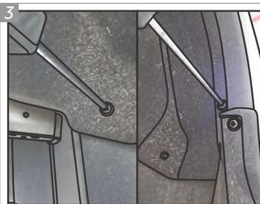
Com uma chave phillips, remova os dois parafusos na parte inferior do parachoque, próximos à roda esquerda do veículo. Remova o protetor plástico do veículo, temporariamente.
