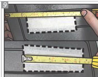
Observe que a distância entre o começo do protetor plástico e o final do recorte deve ser de 18cm e, o comprimento do recorte 12cm. Após, coloque o protetor plástico em sua posição original, dando aperto em todas suas fixações previamente removidas.
