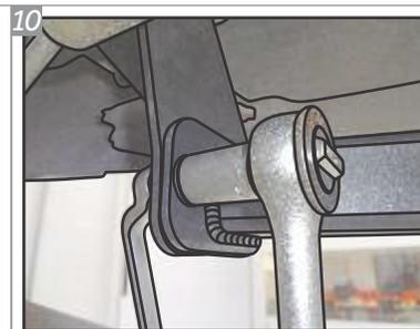
Utilize Parafusos "A", Arruelas "F" e Porcas "D" para fixar o Conjunto Estrutura "N" aos Suportes "M".
