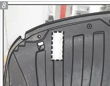
Faça um recorte no protetor plástico conforme a necessidade de passagem do suporte no lado esquerdo. Tendo como base as medidas do próximo passo e a linha pontilhada da imagem acima. Para realizar o corte, pode ser utilizado um estilete ou uma serra de arco.
