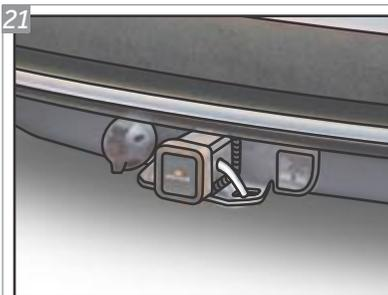
Após colocada, a tampa de proteção deverá ser fixada com o Pino Trava "L" e com o Grampo "K" afim de evitar a perda da mesma.
