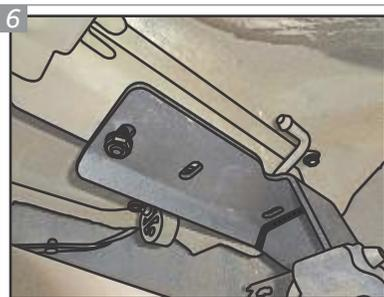
Coloque o Suporte "M" em sua posição, alinhando com os furos do chassi. Fixe o parafuso da Trava M10 "I" com uma Porca "E" e uma Arruela "H", dando aperto final apenas no lado esquerdo.
