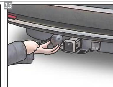
Posicione a Tomada "J" no conjunto estrutura nas furações indicadas e insira os Parafusos "C", com Arruelas "G". Para fixar a tomada, utilize a chave phillips.
