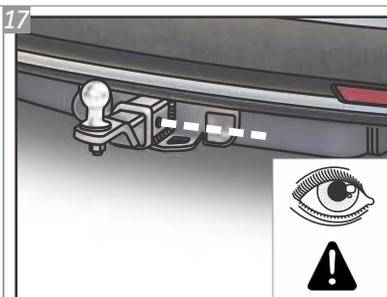
Deslice a ponteira K1 para dentro, de forma que os seus furos e os do engate fiquem alinhados.
