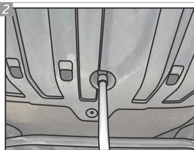
Solte os três parafusos, iguais ao destacado na imagem acima, presentes no protetor plástico.
