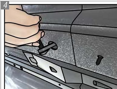
Passe a Trava Frontal "I" pelo furo, direcionando-a para a traseira do veículo. Deixe o parafuso para fora.
