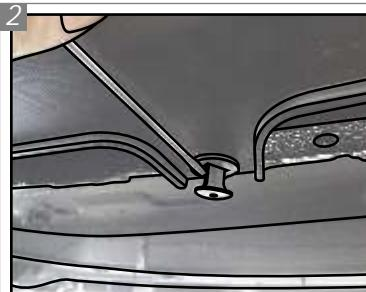
Remova os pinos da segunda e da quinta aba, na parte lateral inferior do veículo. Pode ser necessário remover, temporariamente, uma peça plástica do chassi.
