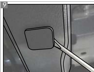
Na parte inferior traseira do chassi do veículo, retire as tampas quadradas, nos dois lados.
