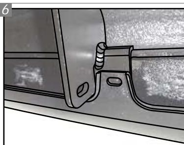
Encaixe a outra extremidade do suporte entre a aba do veículo e a parte plástica.
