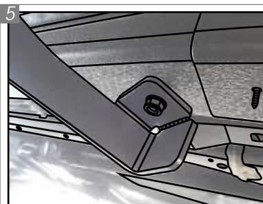
Encaixe o Suporte Dianteiro Direito "P" no parafuso da trava e fixe-o com um Arruela "C" e uma Porca "F". Repita os passos 2-5 para o lado esquerdo, com o Suporte Dianteiro Esquerdo "Q".
