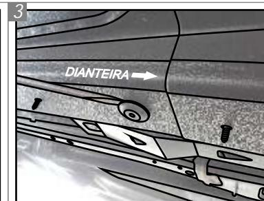
Remover a tampa de borracha na parte inferior frontal do chassi.
