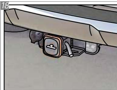
Após colocada, a tampa de proteção deverá ser fixada com o Pino Trava "K" e com o Grampo "J" afim de evitar a perda da mesma.
