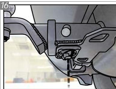
Após posicionar a ponteira K1, localize o o manípulo anti-ruído, na parte inferior do engate. Aperte o mesmo para evitar que a trepidação do veículo, em terrenos irregulares, gere ruídos indesejados.
