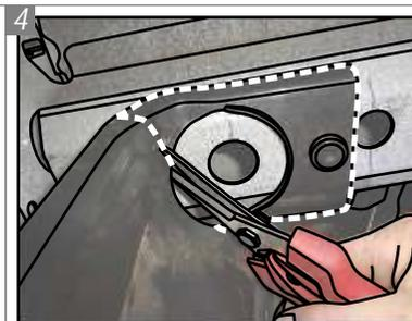
No lado esquerdo do veículo, recorte a peça plástica presa ao chassi (conforme pontilhado), para possibilitar a fixação do suporte.
