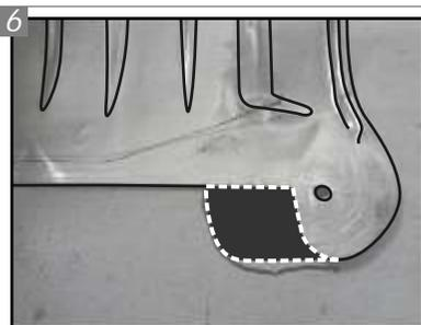
Corte um pedaço da aba, conforme a linha pontilhada, para possibilitar a montagem do suporte esquerdo.
