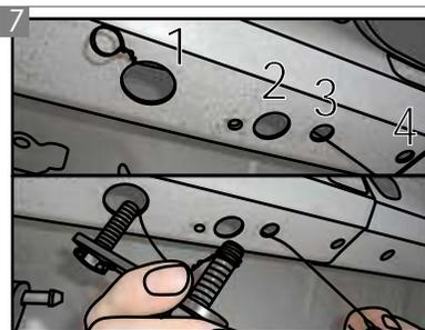
Introduza o arame no furo três do chassi, fazendo com que sua outra extremidade saia pelo furo um. Enrole uma de suas extremidades em um parafuso da Trava Dupla "H".
