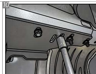
No lado esquerdo, posicione o protetor térmico e o Suporte "L" e fixando-os aos parafusos das Travas Duplas, com Arruelas "G" e Porcas "D". Repita os passos 7-10 no lado direito do veículo.
