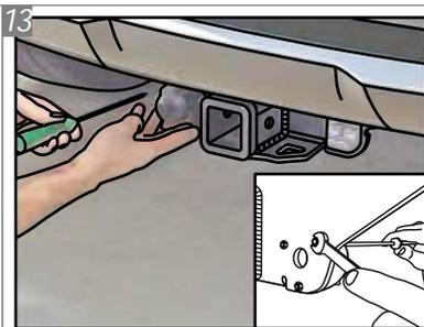
Posicione a Tomada "I" no conjunto estrutura nas furações indicadas e insira os Parafusos "B", com Porcas "E". Para fixar a tomada, utilize a chave phillips e chave 8.
