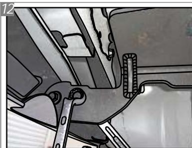
Coloque o Conjunto Estrutura "M" entre os Suportes e fixe-os com Parafusos "A", Arruelas "F" e Porcas "C". Dê aperto final em todas fixações e recoloca todos componentes originais do veículo em suas respectivas posições.
