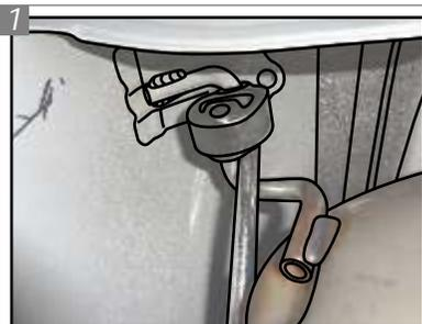
Com uma chave de fenda, solte os dois coxins que prendem o escapamento.
