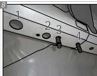
Puxe o arame até que a trava se encaixe nos furos três e quatro.
