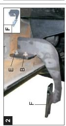
Fixar o suporte "F" utilizando porcas "E", arruelas "B" e os dois parafusos existentes no veículo. Observar para que as dobras do suporte "F" fiquem voltadas para trás. Este passo deverá ser repetido para a fixação dos trás suportes.
