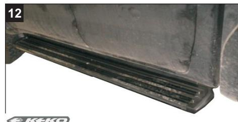
Repetir os passos 8 e 9 para os três suportes. Repetir todos os passos para o lado direito do veículo (lado do passageiro). Quando montado, o estribo deve ficar com o adesivo Keko (detalhe) na parte dianteira nos estribos K, 1 e Estribo K3.
