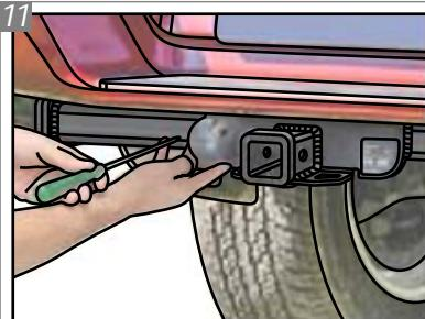
Posicione a Tomada "I" no conjunto estrutura nas furações indicadas e insira os Parafusos "B", com Arruelias "E". Para fixar a tomada, utilize a chave phillips.
