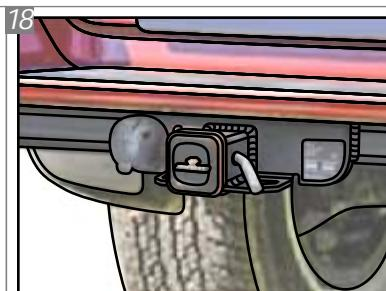
Após colocada, a tampa de proteção deverá ser fixada com o Pino Travamento "K" e com o Grampo "J" afim de evitar a perda da mesma.
