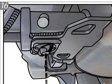
Posicionada a ponteira K1, na parte inferior do engate há um manipulo anti-ruido. Aperte o mesmo para evitar que a tremulação do veículo em terrenos irregulares gere ruídos indesejados.
