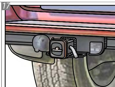
Observe que quando o engate não for utilizado e a ponteira K1 for removida, deve-se colocar a tampa de proteção no local da mesma.
