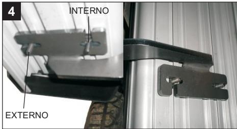
Para inserir a estrutura "C", encaixar primeiro o parafuso externo, e após, deslizar o parafuso interno até o suporte.
