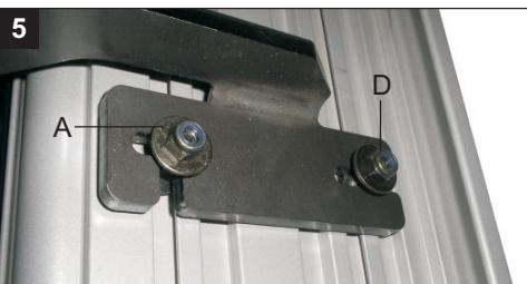
Anfügen mithilfe der Unterlegscheiben "A" und der Gewindemuttern "D".
