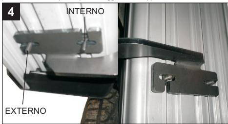
Um die Struktur "C" einfügen zu können, zuerst die externe Schraube einfügen und dann die innenliegende Schraube bis zur Stütze schieben
