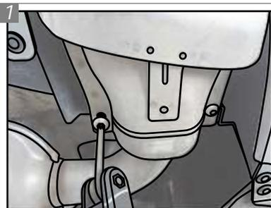
Com uma chave torx 30, remova as duas ponteiros dos escapamentos, completamente.
