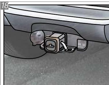
Após colocada, a tampa de proteção deverá ser fixada com o Pino Trava "M" e com o Grampo "L" afim de evitar a perda da mesma.
