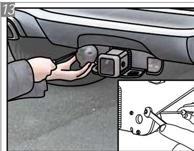
Posicione a Tomada "K" no conjunto estrutura nas furações indicadas e insira os Parafusos "C", com Porcas "F". Para fixar a tomada, utilize a chave phillips e chave 8.
