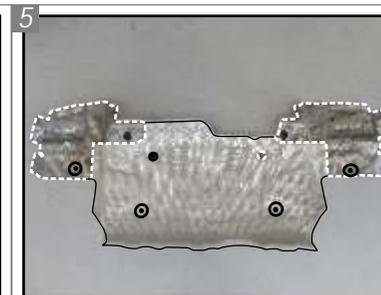
Com uma chave 8, retire o protetor térmico completamente, corte nas regiões de interferência com os suportes (ilustrado acima) e recoloco-o no veículo.
