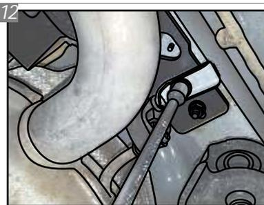
Posicione os suportes dos escapamentos sobre os Suportes "N" e fixe-os com Parafusos "B" e Arruelas "I". Dê aperto final em todas fixações e recoloca todos componentes originais do veículo em suas respectivas posições.
