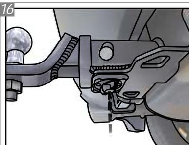
Após posicionar a ponteira K1, localize o o manipulo anti-ruído, na parte inferior do engate. Aperte o mesmo para evitar que a trepidação do veículo, em terrenos irregulares, gere ruídos indesejados.
