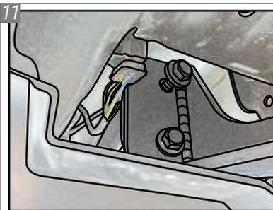
Coloque o Conjunto Estrutura "O" entre os Suportes "N" e fixe-os com Parafusos "A", Arruelas "H" e Porcas "E", dando aperto.
