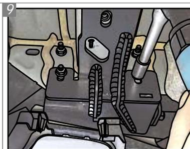
Posicione os Suportes "N" nos parafusos do veículo e fixe-os com as porcas originais, sem dar aperto final.
