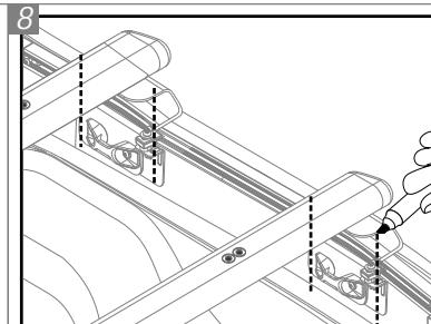
Coloque os perfis laterais na caçamba, temporariamente, e com o auxílio de uma caneta, marque as áreas onde os suportes entram em contato com o EVA dos perfis. Após isso, remova os perfis.
