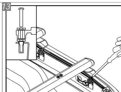
Fixe os perfis da capota aos suportes laterais, com seus parafusos originais e Arruelas "C".
