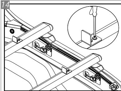
Coloque os Suportes Superiores "E" sobre as barras e fixe-os com Parafusos "B" e Arruelas "D".
