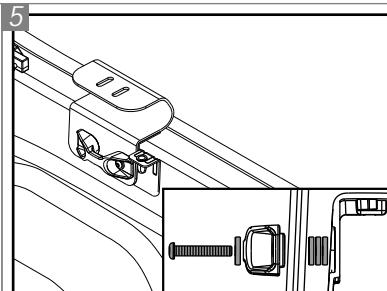
Posicione o suporte da capota, com três Arruelas "C" entre ele e a caçamba, o Suporte Direito "F", o gancho do veículo, mais uma Arruela "C" e um Parafuso "A", para cada furo, conforme detalhado acima.
