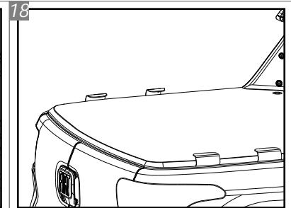
Não remova os suportes após instalá-los. Apenas retire o Conjunto Barra, a fim de evitar infiltração de água ou poeira.
