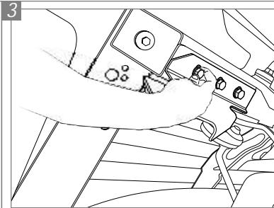
Após, introduza os parafusos "A" com as arruelas de pressão "I" e arruelas lisas "H". Repita os procedimentos no outro lado do veículo.
