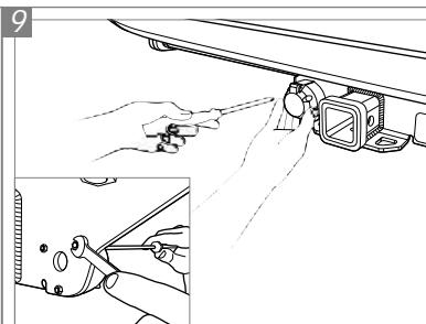
Posicione a tomada "J" no conjunto estrutura nas furações indicadas e insira os parafusos "C". Coloque as porcas "F" na parte traseira do conjunto estrutura para fixação dos parafusos. Para fixar a tomada utilize a chave phillips e chave 8 de boca.
