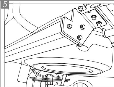
Alinhe as furações da flange do tubo com as furações do suporte "L" e coloque os parafusos "B" com as porcas "G", sem dar aperto. Repita os procedimentos no outro lado do veículo.
