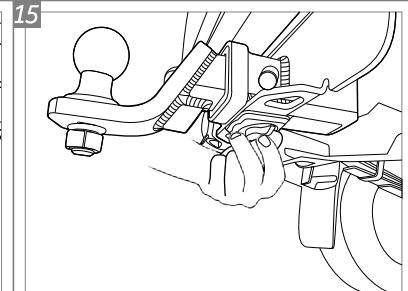
Posicionada ponteira K1, na parte inferior do engate há um manipulo anti-ruido. Aperte o mesmo para evitar que a trepidação do veículo em terrenos irregulares gere ruídos indesejados.
