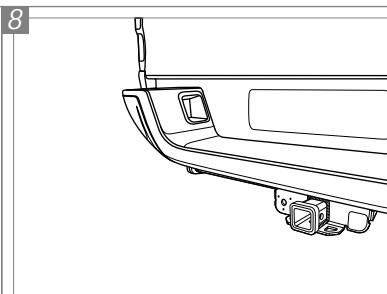
Após realizada a etapa de instalação, observe a o posicionamento do engate para realizar a etapa de montagem.
