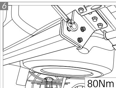
Aperte os três parafusos "B" do tubo central com a força indicada na figura. Repita o procedimento no outro lado.
