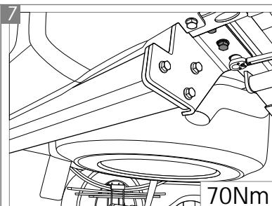
Após, aperte os parafusos do suporte lateral. Aperte-os com a força indicada na figura. Repita o procedimento no outro lado.
