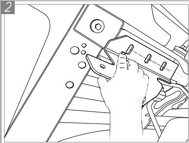
Coloque o suporte lateral "L" de forma que o mesmo fique alinhado com as três furações da trava direita.
