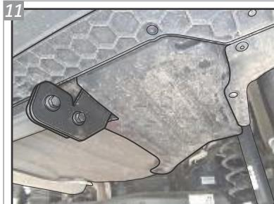
Com os dois Suportes montados, posicione o Conjunto Estrutura "P" entre eles. Para a fixação, utilize Parafusos "A", Porcas "D" e Arruelas "F". Instale a peça plástica novamente no veículo.
