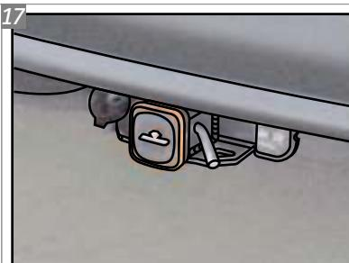
Após colocada, a tampa de proteção deverá ser fixada com o Pino Travá "N" e com o Grampo "M" afim de evitar a perda da mesma.
