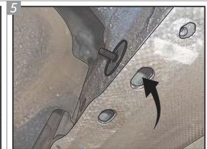
Comece posicionando a Trava "K" na furação lateral. Para isso, ela deve entrar pelo furo destacado e ser gentilmente posicionada com a rosca para o lado de fora do furo lateral. Para evitar que ela caia, coloque a Arruela Plástica "I".
