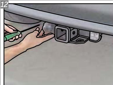
Posicione a Tomada "L" no conjunto estrutura nas furações indicadas e insira os Parafusos "C". Para fixar a tomada, utilize a chave phillips.
