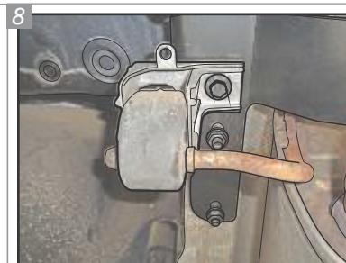
Após fixar o Suporte "N" ao veículo, já é possível fixar novamente o escapamento a estrutura com Parafuso "B" e Arruela "H".
