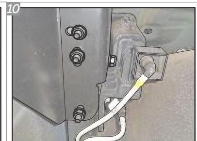
Coloque o Suporte "O" na posição e fixe-o utilizando Porcas "E" e Arruelas "G".
