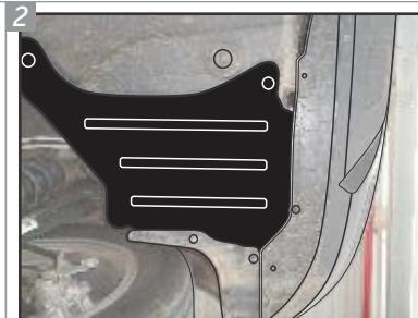
Do lado direito do veículo, solte a peça plástica em destaque, para dar acesso as áreas de fixação do suporte.
