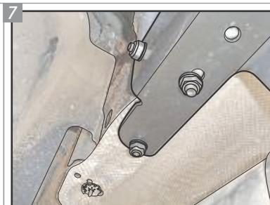
Coloque o Suporte "O" na posição e fixe-o utilizando Porcas "E" e Arruelas "G".
