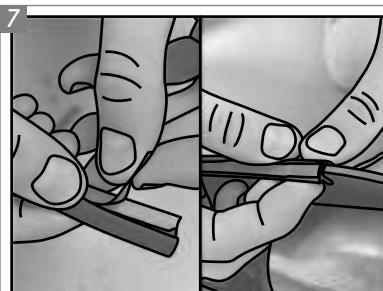
Remova o filme que cobre o adesivo inferior das Borrachas Laterais "H", onde entra em contato direto com a porção plástica do Skid Plate. Coloque as Borrachas nas bordas laterais da parte plástica.
