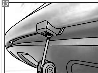
Fixe a aba dos Suportes ao tubo, com Parafusos "A" e Arruelas "E". Remova o restante dos filmes das Borrachas Laterais "H" e pressione o Skid Plate contra o veículo, para que o adesivo das borrachas adira ao mesmo. Dê aperto final em todas fixações.
