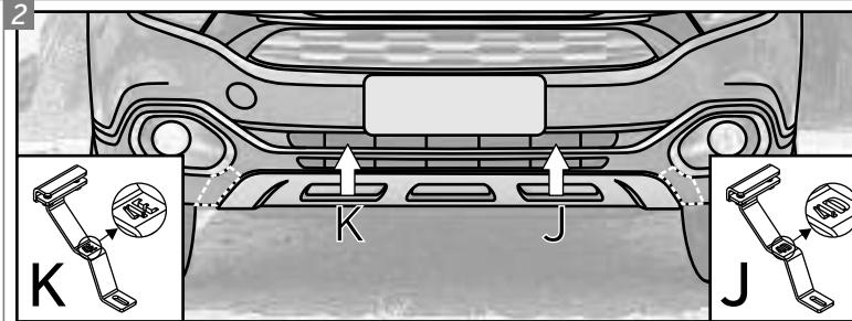
A montagem do acessório no veículo inicia com o posicionamento dos Suportes Frontais "J" e "K" (detalhe). Eles devem ser introduzidos através das aberturas da grade frontal inferior, indicadas pelas setas acima.
