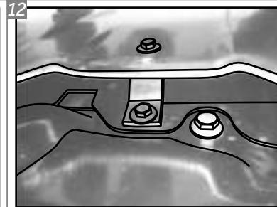
Com um Parafuso "D" e uma Arruela "E", fixe o Skid Plate à Trava Central.
