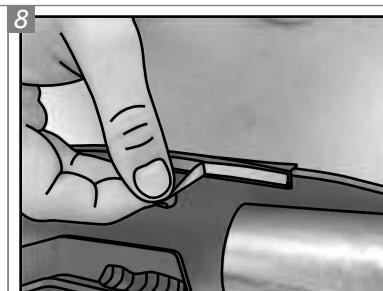
Remova uma pequena parte do filme interno. Sua remoção completa deverá ser efetuada após o final da montagem do acessório no veículo. As Borrachas protegerão o veículo de eventuais danos, causados por trepidação e tremor e ajudarão na adesão da peça.
