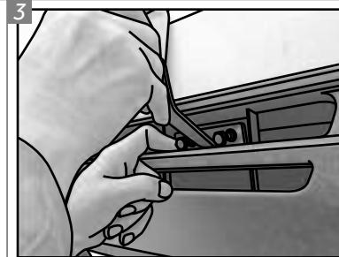
Passe os Suportes Frontais "J" e "K", inteiramente, através da abertura superior da grade frontal inferior do veículo, para depois melhor posicioná-los.
