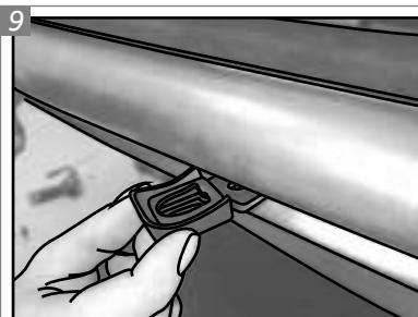
Coloque os Acabamentos Plásticos "I" na extremidade da aba inferior dos suportes, onde entram em contato com o tubo. Posicione o tubo do Conjunto Skid Plate "M" nos suportes frontais.
