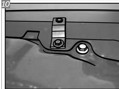
Com um Parafuso "D" e uma Arruela "E", fixe a Trava Central "L" na fixação central inferior da dianteira do veículo, deixando o lado com o rebite virado para frente.
