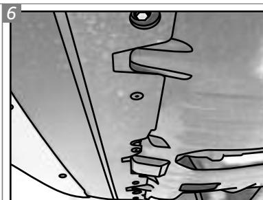
Na porção inferior frontal do veículo, próximo ao final do parachoque, localize os 5 parafusos originais cabeça plana, remova (com uma chave torx T27) e descarte-os.
