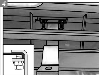
Note que a aba inferior dos suportes deve sair pela abertura inferior da grade do veículo. Posicione os Suportes Frontais "J" e "K", de forma que a parte superior dos mesmos abrace a aba metálica interior do carro.
