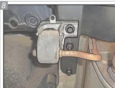
Após fixar o Suporte "S" ao veículo, já é possível fixar novamente o escapamento a estrutura com Parafuso "B" e Arruela "J".
