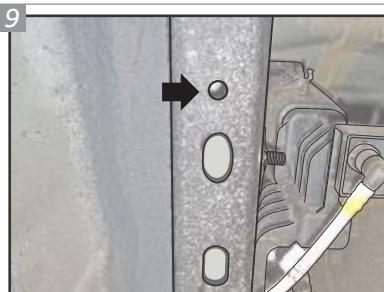
Para o lado direito o procedimento é semelhante, porém, antes de adicionar a Trava "M" deve ser posicionada outra Trava "N" no furo destacado na imagem.
