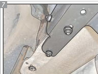
Coloque o Suporte "S" na posição e fixe-o utilizando Porcas "F" e Arruelas "I".
