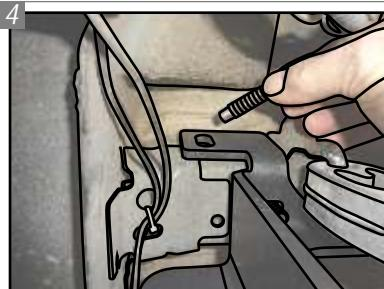
Posicione o Suporte "O" alinhando com os parafusos no chassi e, com o auxílio de um Parafuso "B" e uma Arruela "F", fixe a porca da Trava Dupla, encontrada dentro do chassi.
