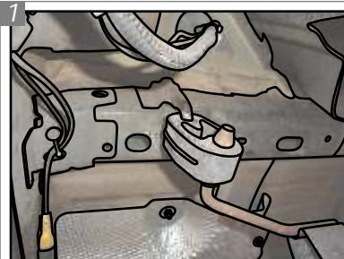
Localize os pontos de fixação na parte traseira do chassi do veículo.
