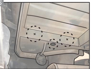
Existem dois pontos cobertos por massa no assoalho que devem ser abertos com uma "pancada" com o auxilio de uma chave de fenda. Uma lima pode ser usada para dar acabamento no furo. No terceiro ponto só deve ser removida uma tampa.
