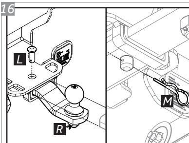
Deslize a Ponteira "R" para dentro, de forma que os seus furos e os do engate fiquem alinhados. Insira o Pino Trava "L" e empurre até que o furo para colocação do Grampo "M" fique visível no lado oposto.
