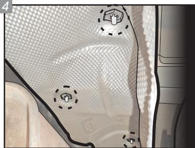
Logo acima do escapamento está posicionado um defletor de calor do sistema. Solte seus fixadores e remova ele temporariamente. Com isso você terá acesso aos pontos de fixação do engate.
