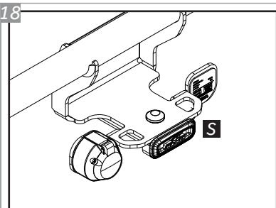
Observe que, quando o engate não for utilizado, a Ponteira deve ser substituída pela Tampa de Proteção "S". Após colocada, a tampa de proteção deverá ser fixada com o Pino Trava "L" e com o Grampo "M" afim de evitar a perda da mesma.
