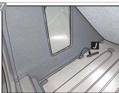
Do lado esquerdo, remova a tampa que fica mais próxima aos bancos. Utilizando o Arame Mola, prenda a Trava Frontal "J" e puxe-a através do furo destampado no passo 5. **A aba mais comprida da Trava deve ficar virada para frente.**
