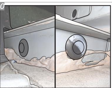
Para o lado esquerdo e direito a configuração é a mesma. Devem ser removidas as tampas de borracha do furos. Com isso, quatro furos ficarão expostos.
