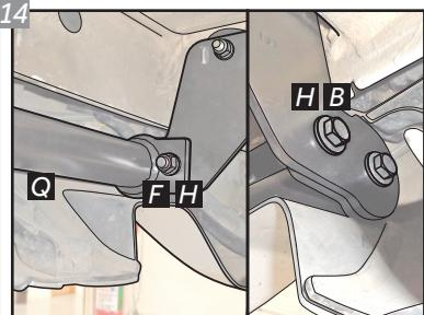
Para montar o Conjunto Estrutura "Q" utilize Parafusos "B", Arruelas "H" e Porcas "F" nos dois lados. Recoloque o estepe, o defletor térmico, o escapamento em seu lugar.
