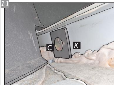
Em cada furo devem ser colocados uma Trava "K" montada com um Parafuso "C" encaixado no furo quadrado. O Parafuso deve atravessar dois furos para a rosca ficar visível.
