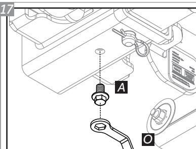
Após posicionar a Ponteira, localize o furo para inserir o Parafuso Anti Ruído, item "A". Aperte o mesmo para evitar que a tremidação do veículo, em terrenos irregulares, gere ruídos indesejados.
