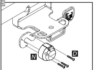
Posicione a Tomada "N" no conjunto estrutura nas furações indicadas e insira os Parafusos "D". Para fixar a tomada, utilize a chave phillips.
