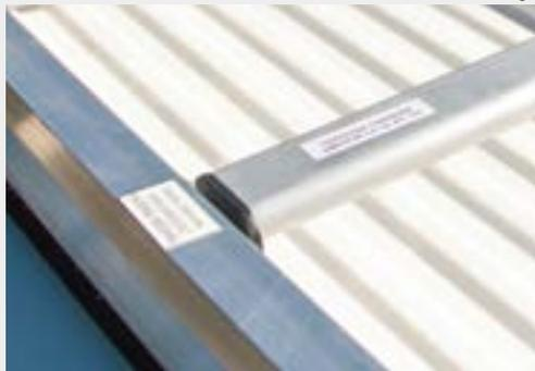
Caso as travessas não sejam posicionadas corretamente, a lona poderá formar uma bacia para baixo que, se exposta à chuva, permitirá o acúmulo de água, tendo como consequência a sobrecarga nas laterais da capota, ocasionando a quebra das travas laterais.
