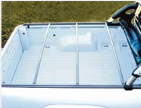
Outro ponto a ser observado é a **POSIÇÃO DAS TRAVESSAS** ou varões removíveis que sustentam a lona. Sempre que a lona estiver fechada essas travessas devem estar devidamente posicionadas, possibilitando a sustentação adequada. Existem capotas com uma, duas ou até três travessas removíveis – elas devem estar posicionadas na mesma distância, de modo que coincidam com os **ADESIVOS POSICIONADORES**.
