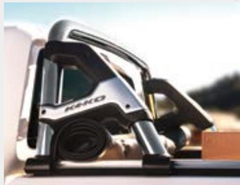
**QUANDO A CARGA** carregada no veículo for mais alta que a caçamba, ou seja, se ela encostar ou ultrapassar a posição da lona, é recomendável enrolar a lona. A carga não deve forçar a lona para cima, pois isso poderá ocasionar problemas em toda a estrutura do produto.
