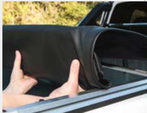
Para **ENROLAR A LONA**, deve-se observar que a parte externa superior esteja para fora. O manual do produto traz imagem ilustrativa desse procedimento. Atenção: quando a lona é enrolada com a parte interna (inferior) para fora, expõe os perfis flexíveis e o sistema de travamento, podendo danificá-los.
